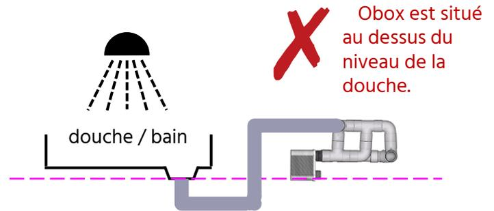
Pour fonctionner, Obox doit être posé horizontalement sur son socle.
