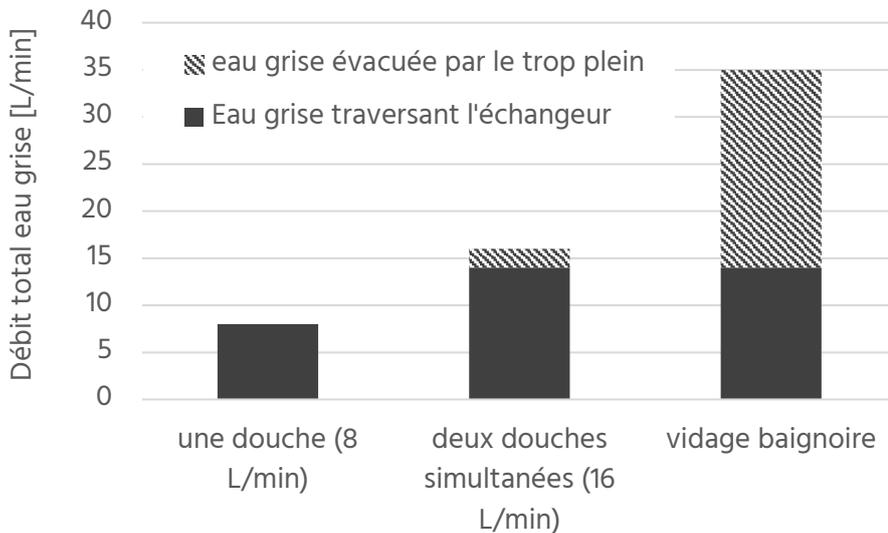
Ce trop-plein permet également d'assurer un écoulement normal des eaux usées quel que soit l'état d'encrassement de l'échangeur.
