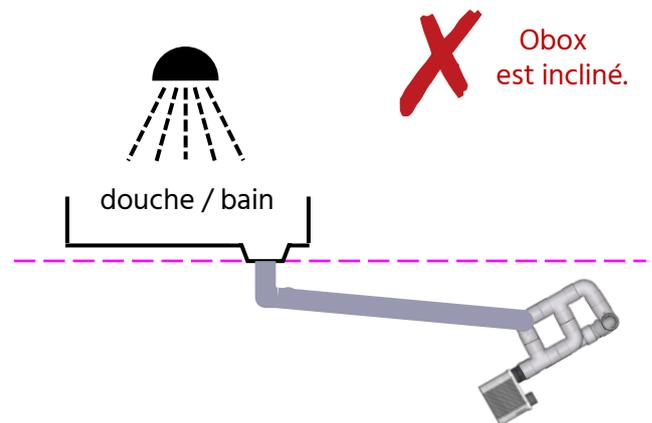
Obox ne doit pas recevoir les eaux usées des WC (eaux noires). Il est possible d'y envoyer les eaux usées de lave-vaisselle, lave-linge, ou cuisine mais la plus value énergétique ne compense que très rarement le surcoût et le supplément de débris / dépôt.
